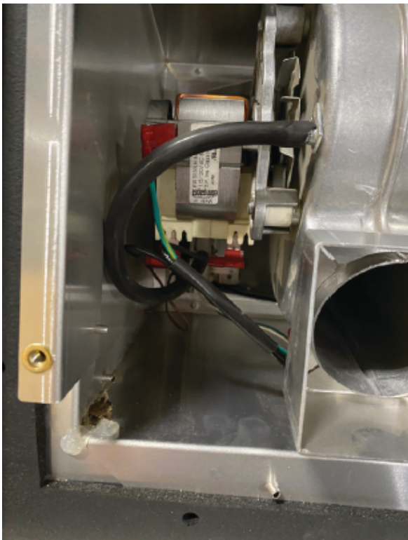
Figure 8.8 - Emplacement des vis de fixation de l'interrupteur d'aspiration
