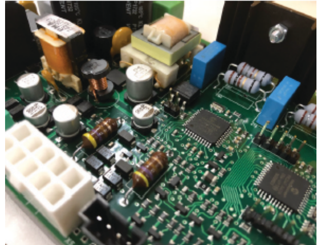
Figure 7.3 - Retirer le cavalier JP1 du nouveau module de contrôle IFC pour Power Vent
