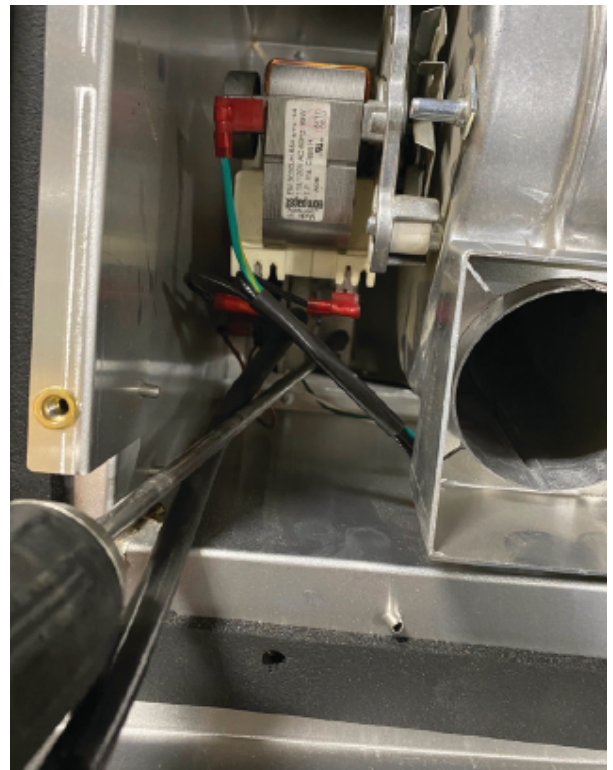
Figure 8.9 - Retrait de l'interrupteur d'aspiration
