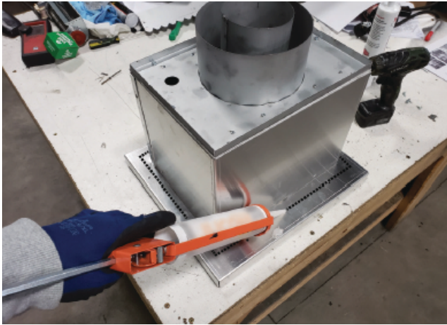
Figure 6.5 - Appliquer du silicone à la face arrière
