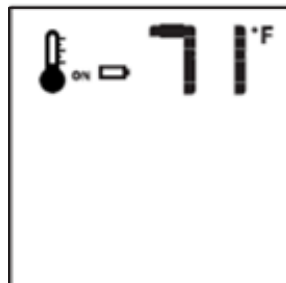
Figure 9.13 - Faible charge des piles
