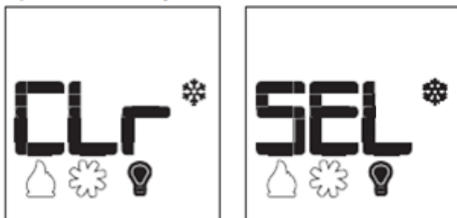
Figure 9.11 - Désactivation du kit d'éclairage
