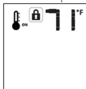
Figure 9.3 - Verrouillage des touches
