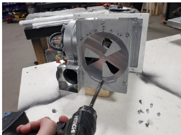
Figure 2.4 - Desserrer la vis de blocage
