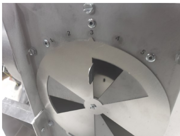
Figure 2.6 - Ajustement montré en Position 3
