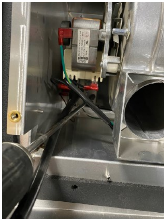
Figure 8.9 - Retrait de l'interrupteur d'aspiration
