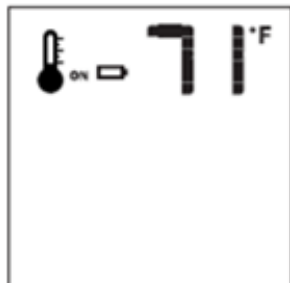
Figure 10.17 - Faible charge des piles
