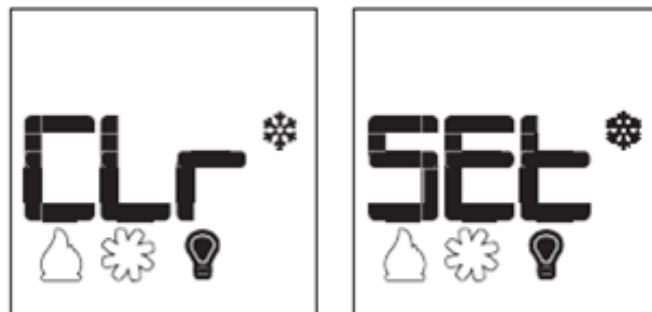
Figure 10.13 - Désactivation du réglage d'éclairage plafonnier
