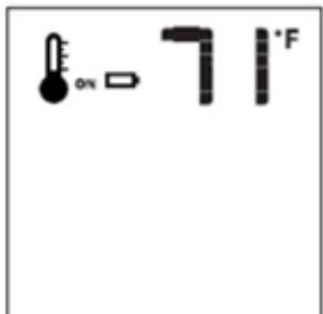
Figure 10.17 - Faible charge des piles
