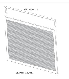
POSITION THE HEAT DEFLECTOR BY SLIDING IT UNDER THE MOUNTING TABS AS SHOWN
