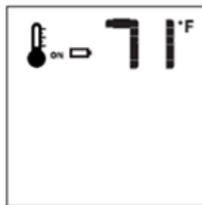
Figure 10.13 - Faible charge des piles
