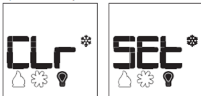
Figure 10.12 - Désactivation du kit d'éclairage plafonnier
