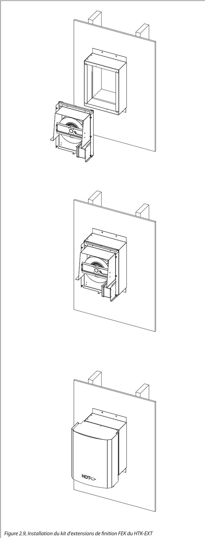
Figure 2.9, Installation du kit d'extensions de finition FEK du HTK-EXT
