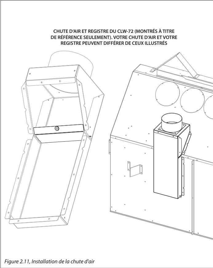
Figure 2.11, Installation de la chute d'air
