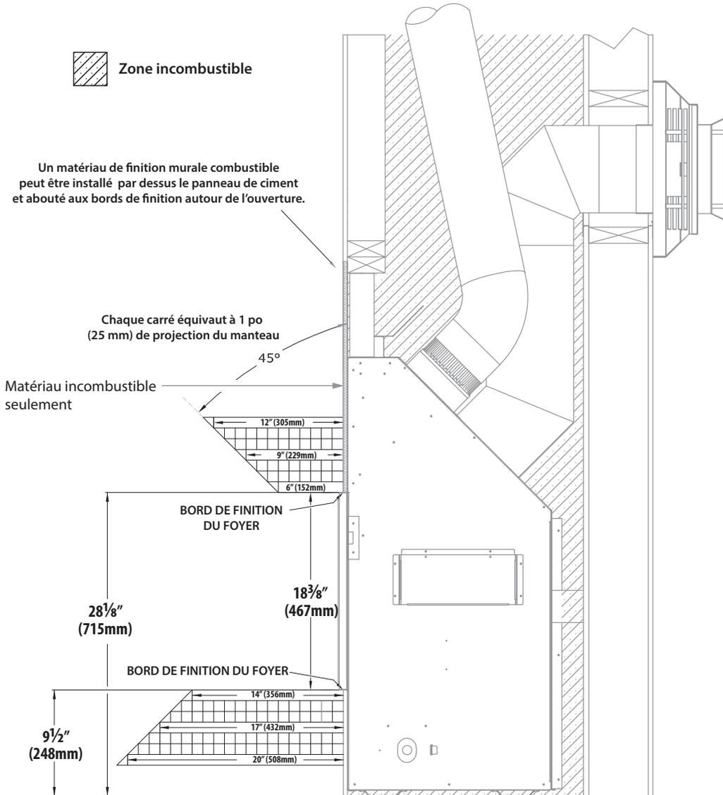
Figure 4.13, Dégagements de l'âtre et du manteau pour une installation sans contour
