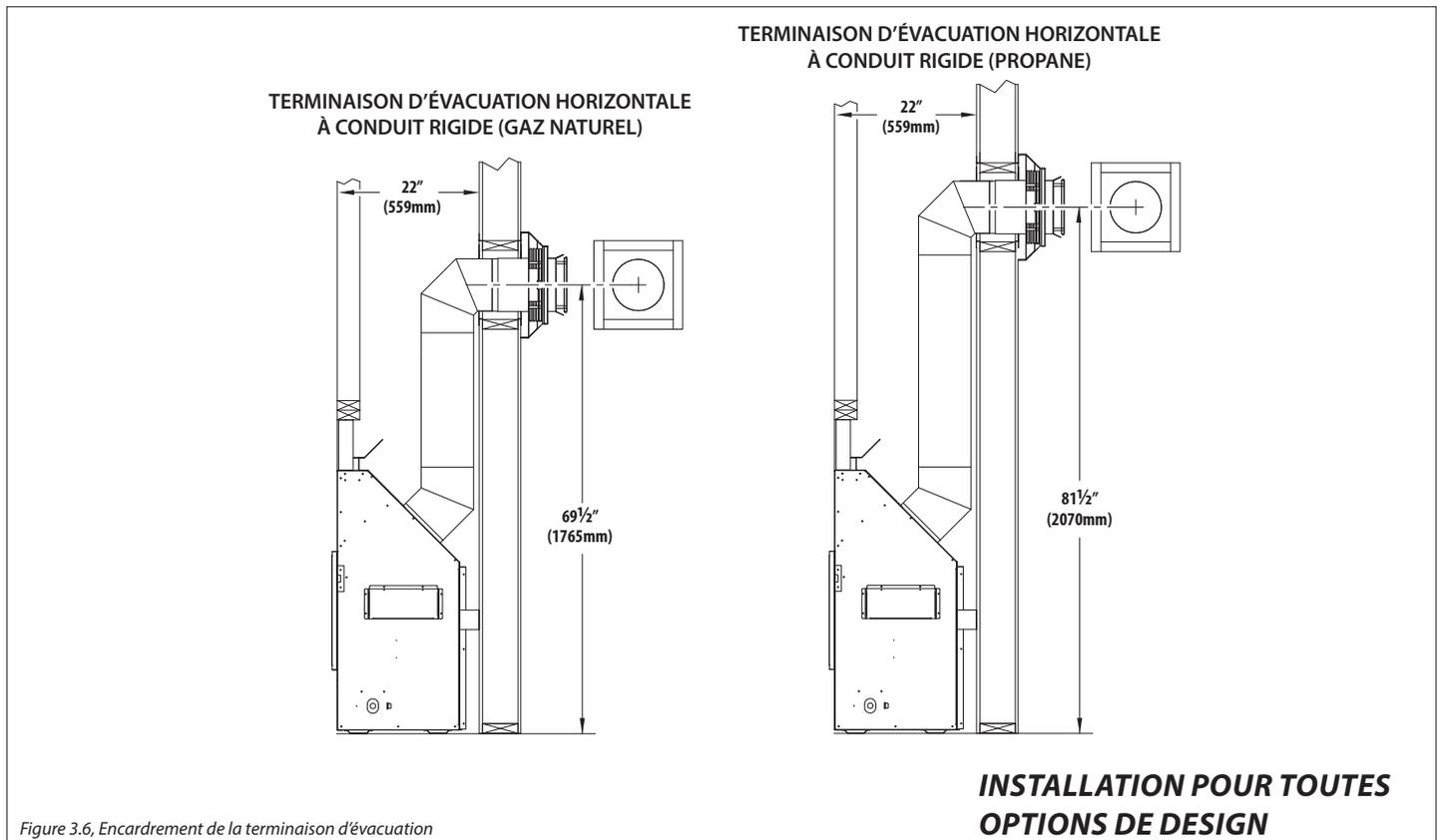
Figure 3.6, Encadrement de la terminaison d'évacuation
