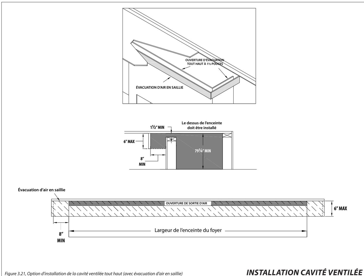
Figure 3.21, Option d'installation de la cavité ventilée tout haut (avec évacuation d'air en saillie)
