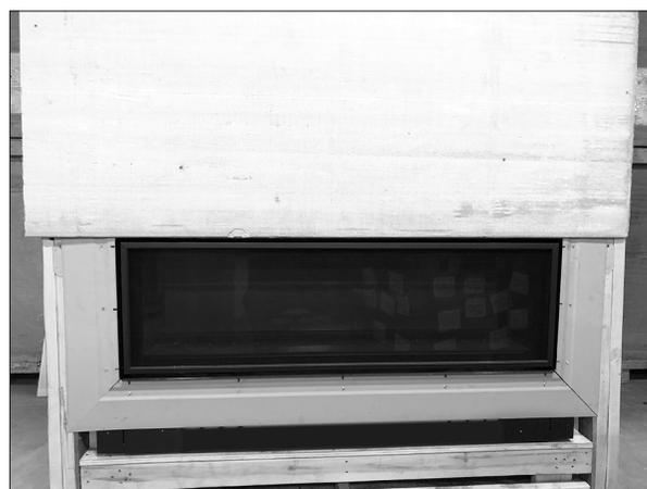
Figure 4.9, Panneaux et matériaux incombustibles installés
