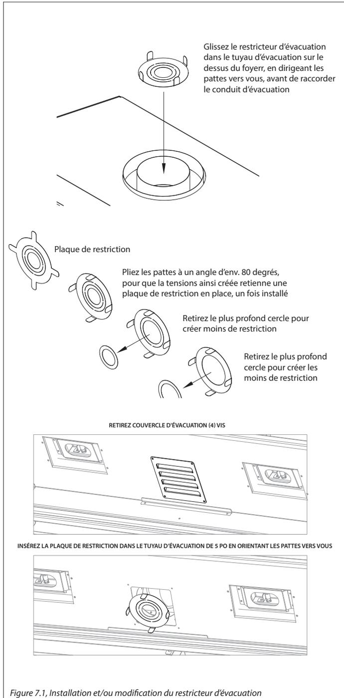
Figure 7.1, Installation et/ou modification du restricteur d'évacuation
