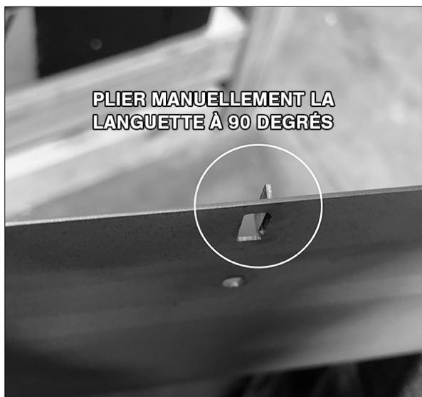
Figure 4.6, Languette pliée manuellement
