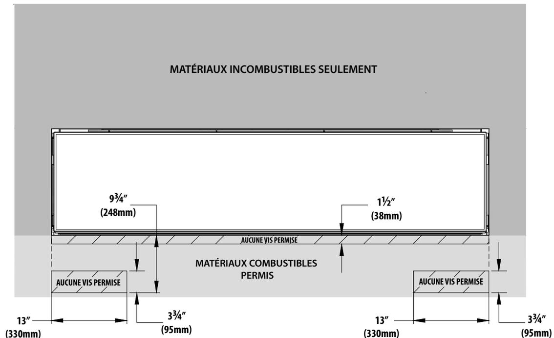
Figure 4.5, Dimensions minimums des matériaux incombustibles emplacements de vis
