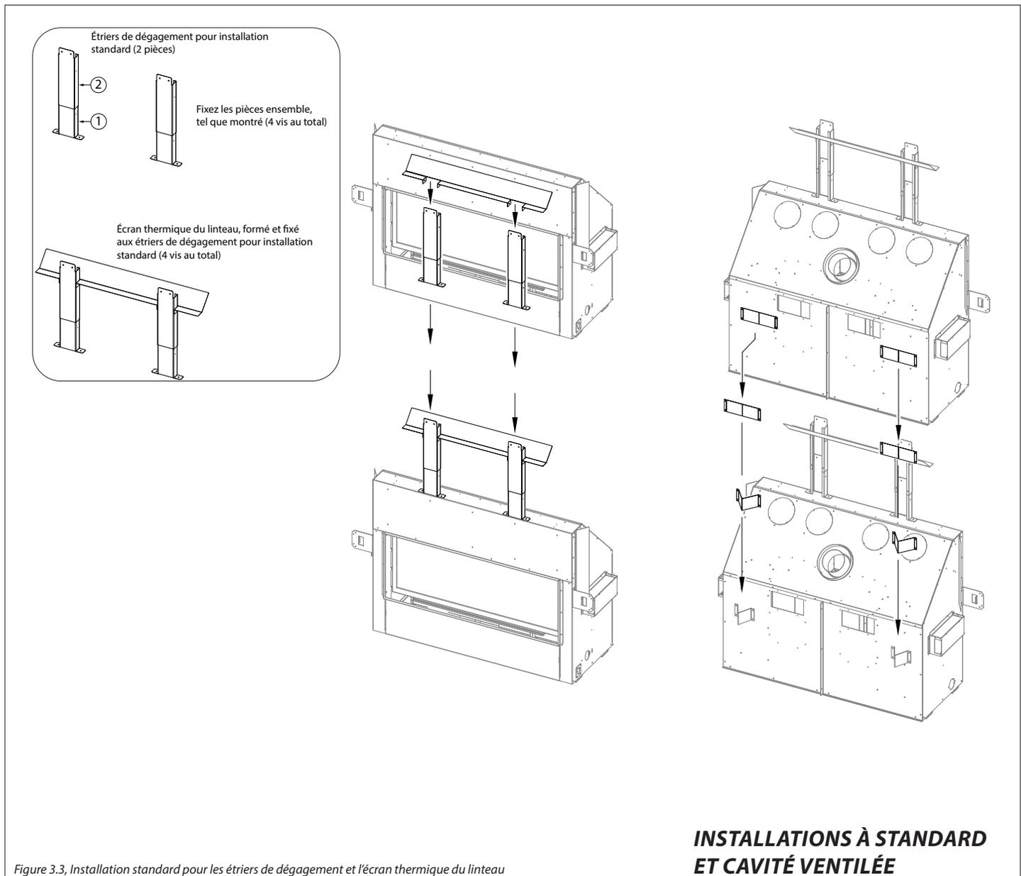
Figure 3.3, Installation standard pour les étriers de dégagement et l'écran thermique du linteau
