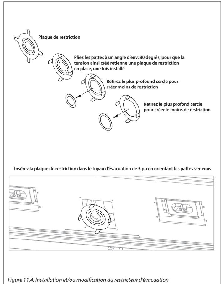
Figure 11.4, Installation et/ou modification du restricteur d'évacuation
