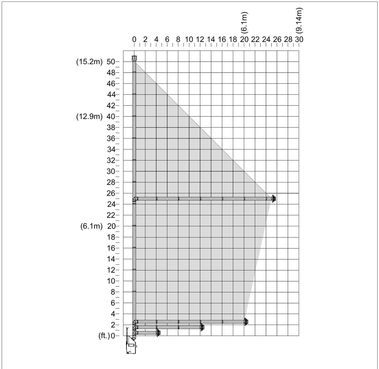
Figure 7.2, Conduit d'évac. combiné (gaz naturel et propane)
