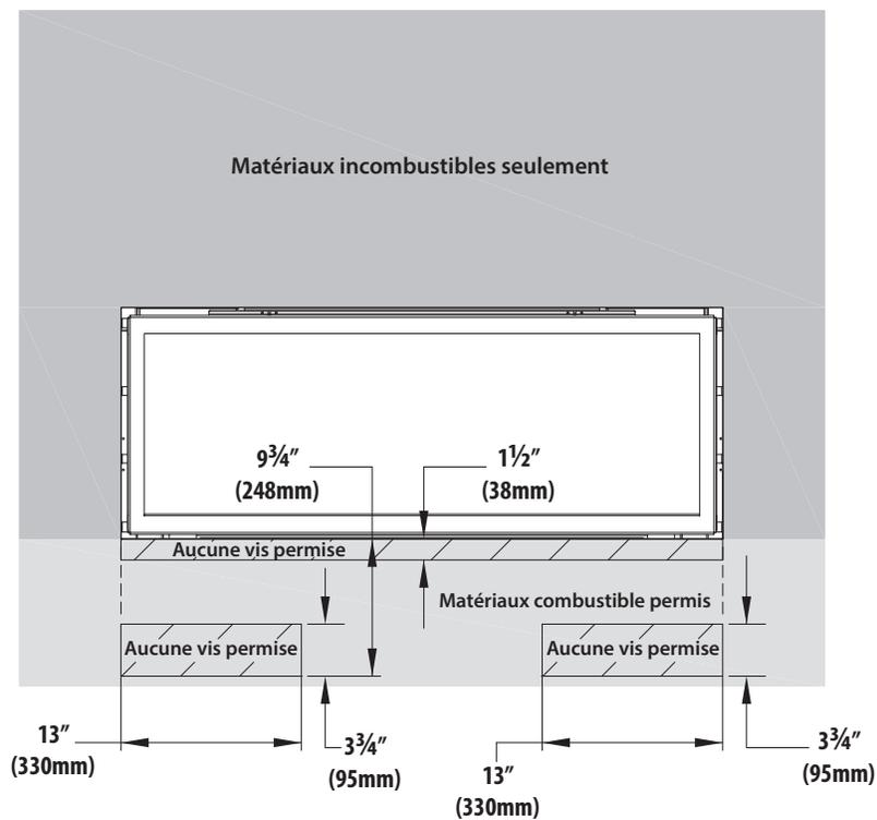
Figure 4.15, Dimensions minimums des matériaux incombustibles emplacements de vis
