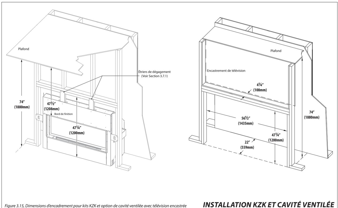
Figure 3.15, Dimensions d'encadrement pour kits KZK et option de cavité ventilée avec télévision encastrée
