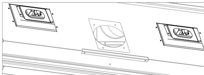
Figure 7.1, Installation et/ou modification du restricteur d'évacuation
