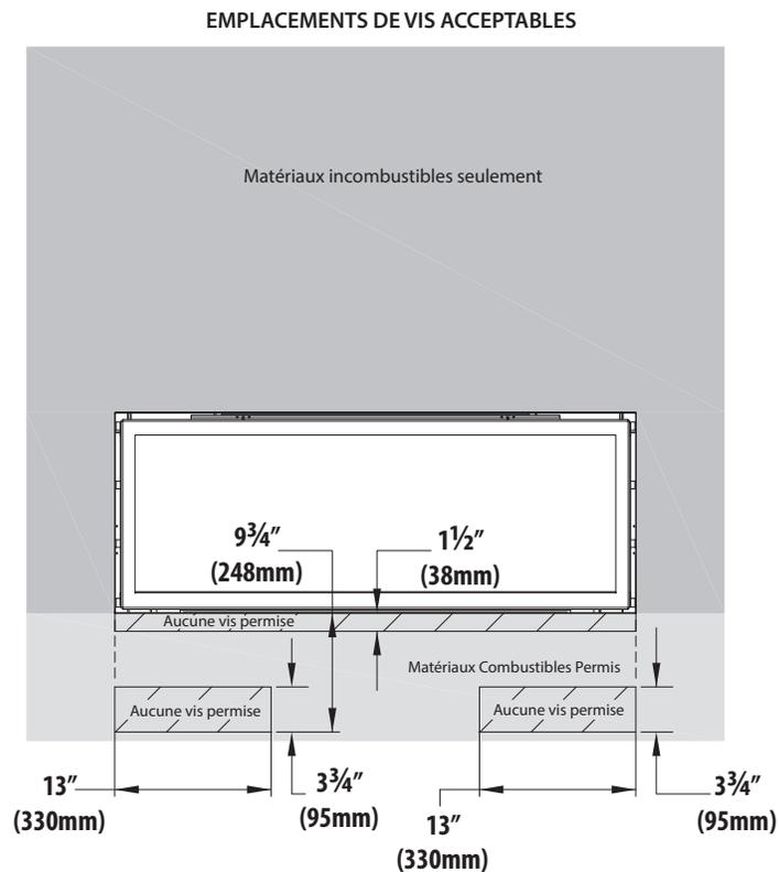
Figure 4.5, Dimensions minimums des matériaux incombustibles emplacements de vis
