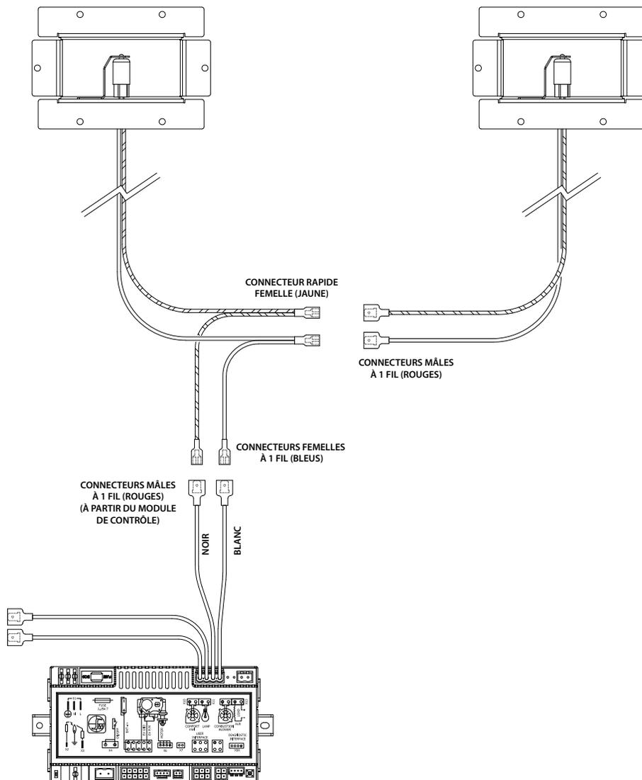
Figure 9.3, Schéma de câblage pour la kit d'éclairage
