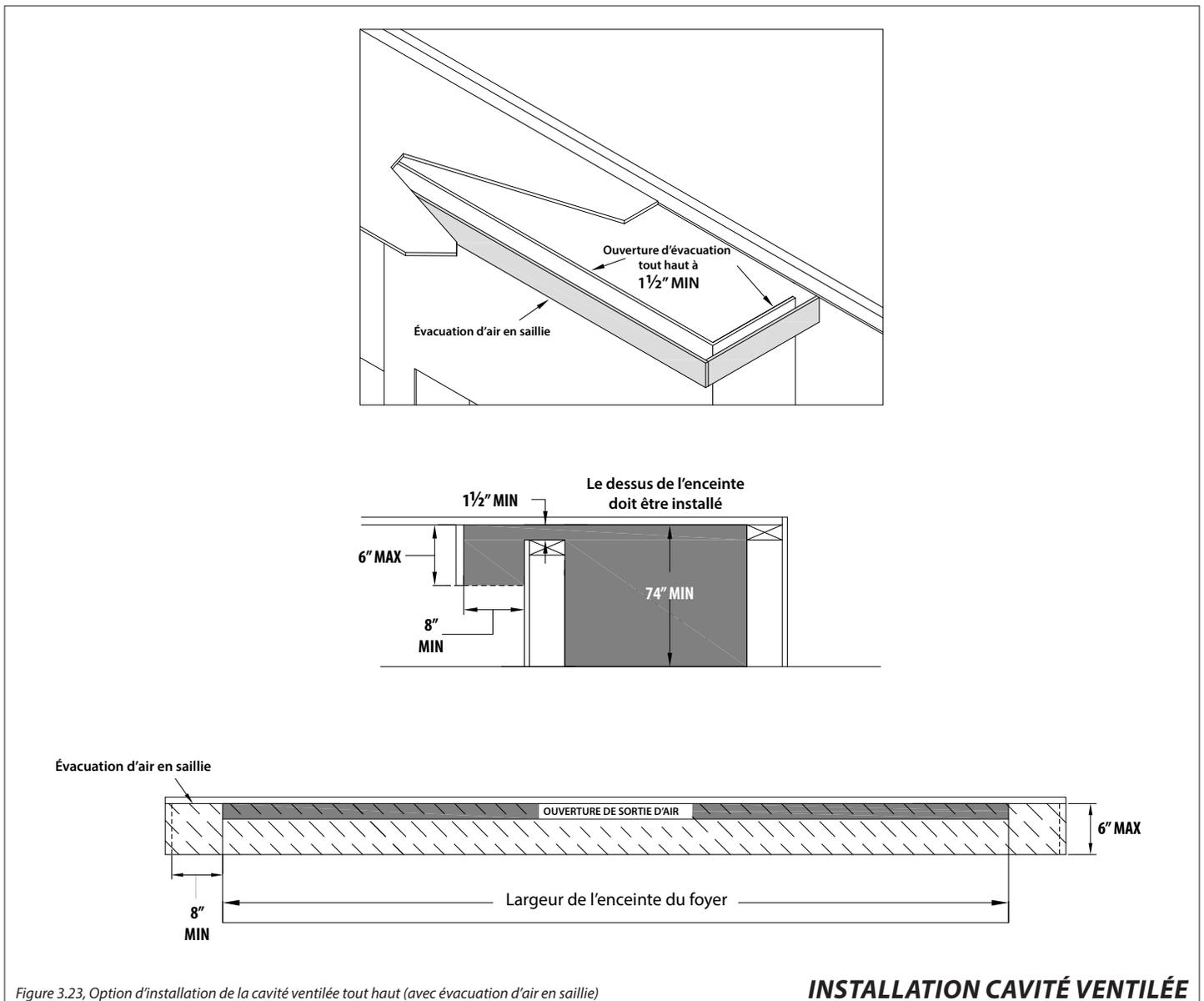
Figure 3.23, Option d'installation de la cavité ventilée tout haut (avec évacuation d'air en saillie)
