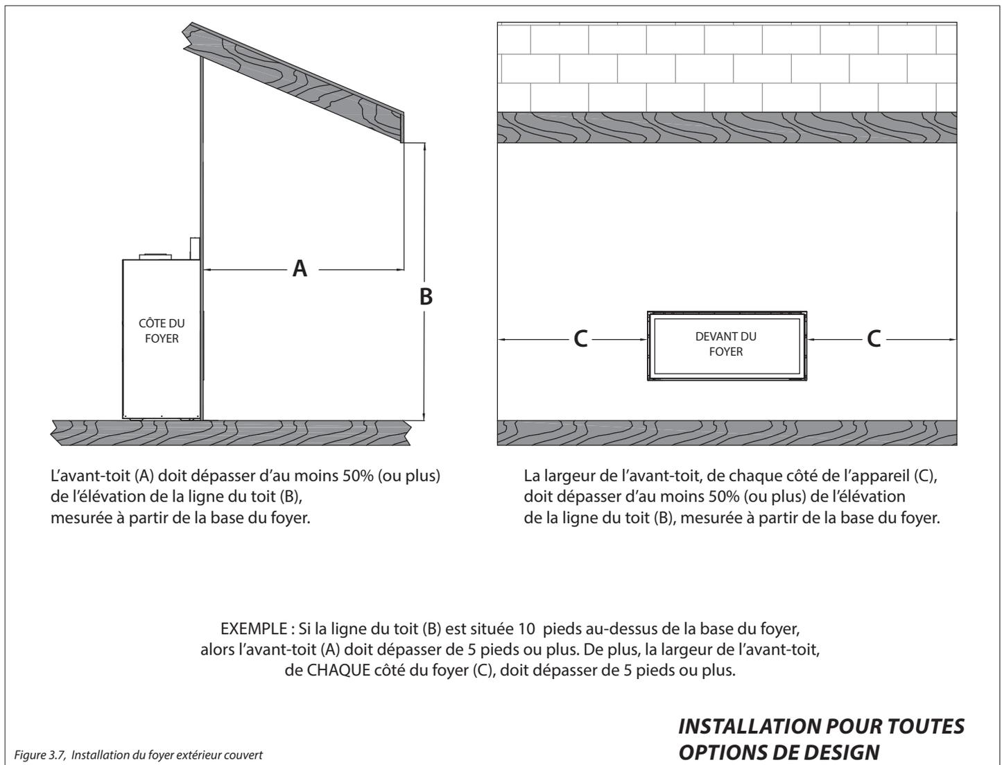
Figure 3.7, Installation du foyer extérieur couvert
