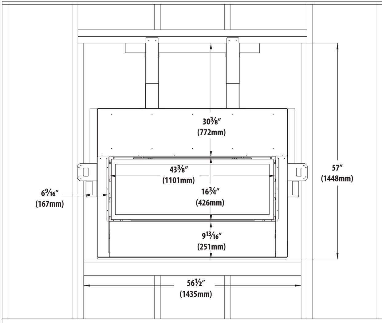
Figure 4.3, Dimensions de l'ouverture finie
