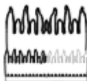
Flammes orange foncé à pointes noires (Venturi trop fermé. Ouvrir légèrement le venturi)
