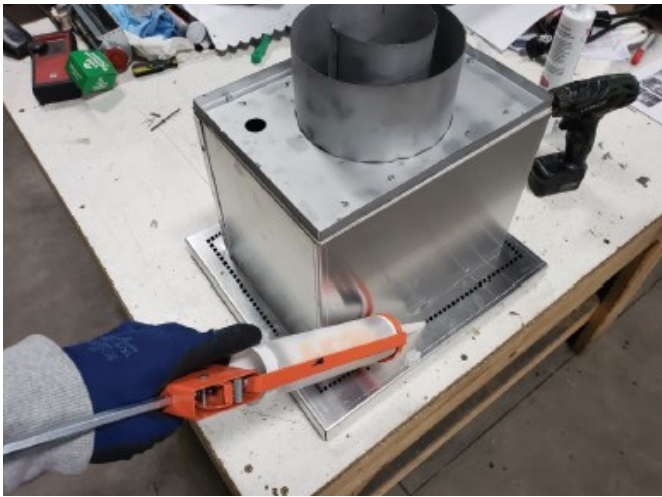
Figure 6.5 - Appliquer du silicone à la face arrière
